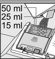
Моющее средство следует загружать лишь в сухую предназначенную для него ячейку.
