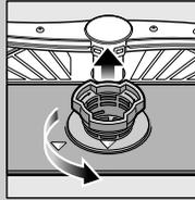
Поверните цилиндрический фильтр, извлеките фильтрующую систему ...
