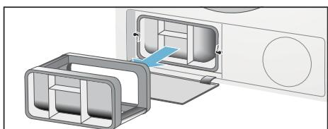
5. Entnehmen Sie den Wärmetauscher.
