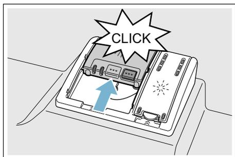
La cámara del detergente se abre automáticamente y en el instante adecuado, según el programa de lavado seleccionado. Los detergentes en polvo o líquido se reparten por todo el interior de la cuba del aparato, disolviéndose. Las pastillas de detergente, por su parte, son recogidas en la bandeja correspondiente, donde se disuelven de un modo dosificado.
