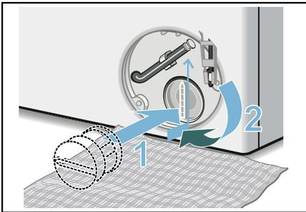
8. Service-Klappe einsetzen und einrasten.
