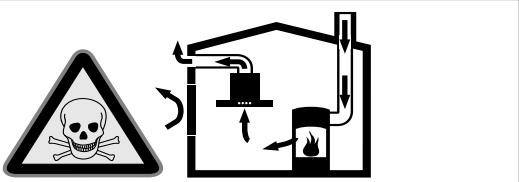
Eldstäder som är beroende av rumsluft (t.ex. värmearrapparater som drivs med gas, olja, ved eller kol, genomströmningsapparater, varmvattenberedare) tar sin förbränningsslut ur det utrymme där enheten är installerad och leder ut avgaserna i det fria via en avgasanläggning (t.ex. skorsten).
