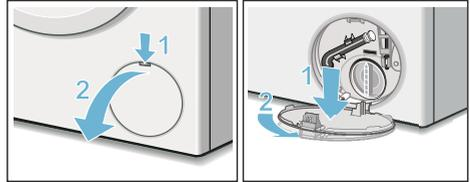
4. Extraer el tubo auxiliar de desagüe de su soporte. Retirar el tapón de cierre y recoger el agua de lavado en un recipiente adecuado. Encajar el tapón de cierre en el tubo de desagüe y colocarlo en su soporte.
