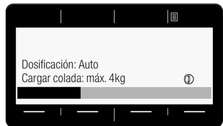
La barra indicadora del estado de carga va creciendo conforme se introduce la ropa. En caso de superar la máxima carga de ropa admisible, la barra indicadora parpadea. Tener en cuenta la carga máxima admisible. La sobrecarga de la lavadora afecta al resultado de lavado y fomenta la formación de arrugas en las prendas.
