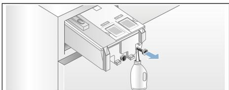
d) Introducir el tapón hasta el tope en la manguera de desagüe.
