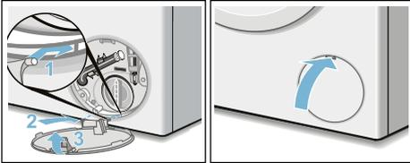
**Nota:** Con objeto de evitar que en el próximo lavado se evacue detergente sin haber sido usado: verter 1 litro de agua en la cámara
