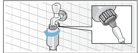
2. En los modelos estándar y Aqua-Secure, limpiar el filtro de la parte posterior del aparato: Retirar la manguera de la parte posterior del aparato. Extraer el filtro con ayuda de unos alicates y limpiarlo.
