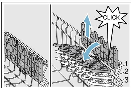
\* 根据不同洗碗机的配置，您可将叠架调整为 3 倍高度。
