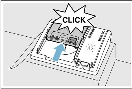
依洗涤程序的设置，洗涤剂槽会自动在正确的时间开启。粉状或液状洗涤剂会散布并溶解在洗碗机内；锭剂会落在锭剂收集盘上，并在此溶解。
