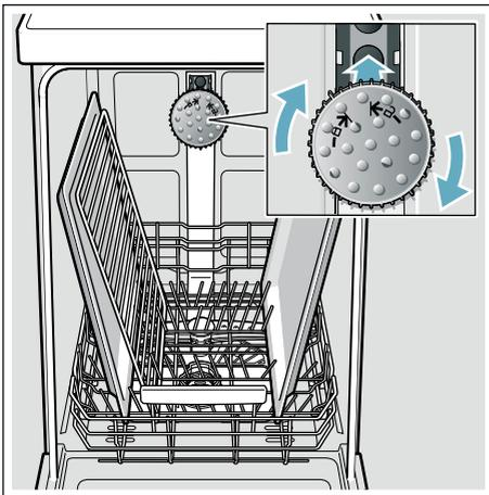
Damit der Sprühstrahl alle Teile erreichen kann, ordnen Sie die Bleche wie abgebildet ein (maximal 2 Backbleche und 2 Gitter).
