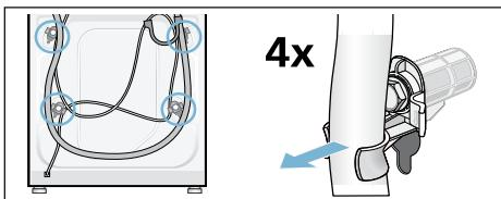
2. Dévisser les 4 cales de transport à l'aide d'une clé plate SW13 et les retirer.
