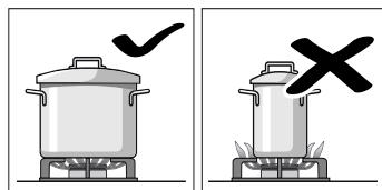
Χρησιμοποιήστε σκεύη κατάλληλου μεγέθους για κάθε καυστήρα.
