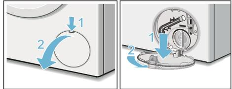
4. Sortir le flexible de vidange de sa fixation. Retirer le bouchon de fermeture, laisser le bain lessiviel s'écouler dans un récipient adéquat. Enfoncer le bouchon de fermeture et mettre le flexible de vidange en place dans la fixation.
