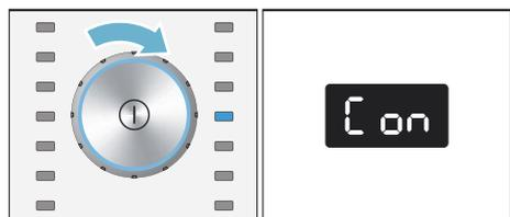
4. Appuyez sur la touche Départ. **on** (activé) apparaît dans le bandeau de commande. La fonction Wi-Fi est désormais activée sur l'appareil. **off** (désactivé) apparaît dans le bandeau de commande. La fonction Wi-Fi est désormais désactivée sur l'appareil.
