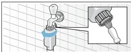
2. Nettoyage du filtre à l'arrière de l'appareil sur les modèles Standard et Aqua-Secure : Retirer le flexible au dos de l'appareil, Extraire le filtre avec une pince et le nettoyer.
