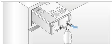
d) Réintroduire le bouchon obturateur jusqu'en butée.
