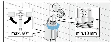
**Remarque :** Ouvrir prudemment le robinet d'eau tout en vérifiant si les raccords sont étanches. La jonction par vis se trouve sous la pression régnant dans la conduite d'eau.
