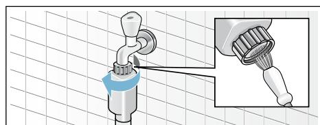
6. Standart ve Aqua-Secure modellerinde cihazın arka tarafındaki süzgeci de temizleyiniz:
