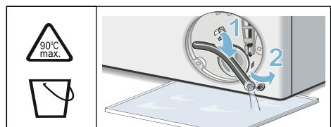
5. Pompa kapağını dikkatlice söküñüz, kalan su dışarı akabilir. İç bölümü, pompa kapağı dişlerini ve pompa gövdesini temizleyiniz. Pis su pompası fan göbeği dönüyor olmalıdır. Pompa kapağını tekrar yerleştiriniz ve sıkıştırınız. Kol dik konumda durmalıdır.
