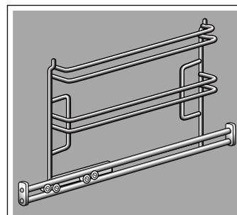
Rámy odpovídají pouze vpravo nebo vlevo. Musí být možné vytáhnout výsuvné lišty směrem dopředu.
