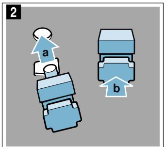
3. Držák vzadu zavěste hákem do horního otvoru **a** a zatlačte do dolního otvoru **b** (obrázek 3).
