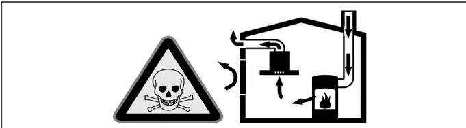
Raumluftabhängige Feuerstätten (z.B. gas-, öl-, holz- oder kohlebetriebene Heizgeräte, Durchlauferhitzer, Warmwasserbereiter) beziehen Verbrennungsluft aus dem Aufstellraum und führen die Abgabe durch eine Abgasanlage (z.B. Kamin) ins Freie.
