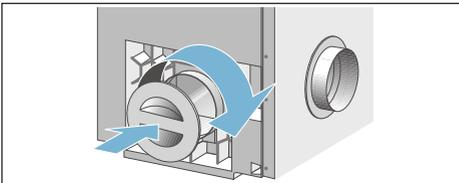
**Hinweis:** Falls sich viel Kondensat im Abluftrohr ansammelt, wird empfohlen, einen Kondensatbehälter (Standard) oder eine Ablauföffnung mit einem Durchmesser von mindestens 3 mm im untersten Teil des Abluftrohrs anzubringen.
