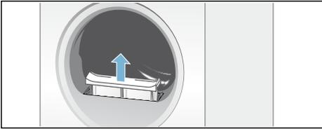
3. Die Flusen aus der Mulde des Flusensiebes entfernen.
