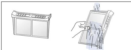
6. Das Flusensieb trocknen, schließen und wieder einsetzen.
