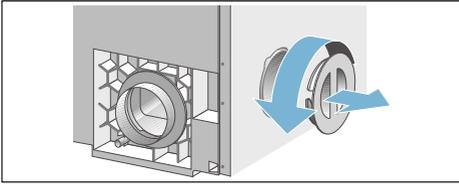
2. Den Bajonett-ring von der Rückwand entfernen und an der Öffnung auf der Seitenwand anbringen.
