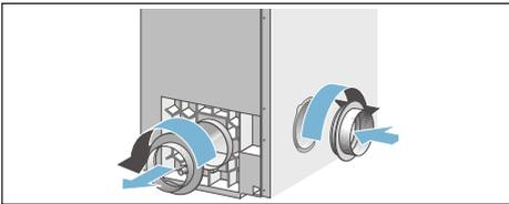
3. Die Öffnung in der Rückwand mit der Abdeckung verschließen.
