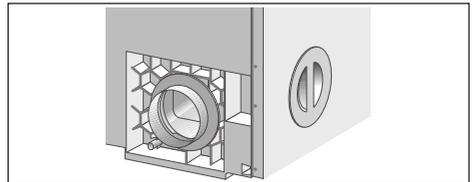
Die Abluftöffnung in der Rückwand ist im Lieferzustand des Trockners offen (Bajonetting). Die Abluftöffnung in der linken Seitenwand ist mit einer Abdeckung verschlossen.
