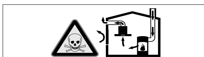
Hava dolaşımlı ateşlikler (örneğin gaz, yağı, odun veya kömürle çalışan sobalar, şofbenler, su ısıtıcıları) yanma havasını kurulum yerinden alırlar ve atık gazı bir atık gaz sistemi (örneğin baca) kanalıyla dışarıya aktarırlar.
