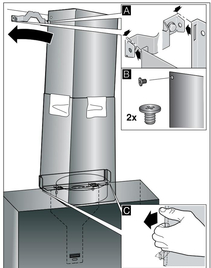
7. Untere Kaminverblendung am Haltewinkel einklipsen. Das Anschlusskabel darf nicht beschädigt werden! **C**
