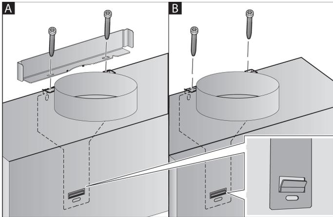
5. Wird kein Kanal montiert, die zwei Sicherungsschrauben ohne Winkel festschrauben. **B**
