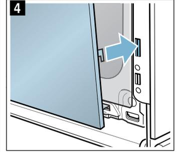
5. Exerça pressão sobre a parte inferior do vidro frontal, até que encaixe de forma audível (figura 5).
