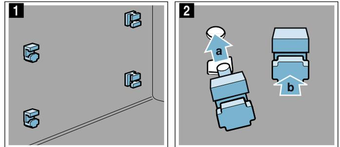
3. Insira o suporte de trás com o gancho no furo superior **a** e pressione para o furo inferior **b** (figura **3**).
