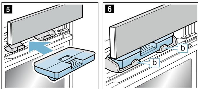
9. Empurre a aba lentamente para baixo e, em seguida, pressione para trás, até fechar completamente. O depósito de água está cheio. Pode iniciar as operações com vapor.
