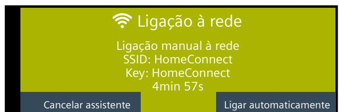
4. Registe o aparelho móvel na rede do forno com a SSID "HomeConnect" e o código "HomeConnect".
