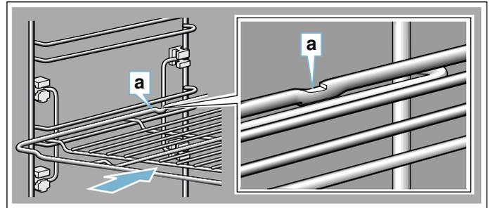
Ao inserir a grelha, certifique-se de que a lingueta de bloqueio **a** se encontra atrás e de que está virada para baixo. A frente da chanfradura do acessório **b** deve estar virada para a porta do aparelho.
