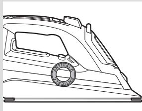
تم تصميم خرطوشة “anti-calc” لقليل تكون الترسبات الكلسية الناتجة أثناء الكي بالبخار وهي تساهم في إطالة عمر استخدام المكواة. ولكن مع ذلك لا تستطيع خرطوشة “anti-calc” “منع بعض الترسبات الكلسية التي تنتج بشكل طبيعي بمرور الزمن. ونتيجة لذلك، تم تصميم وظيفة “calc'n Clean” (تنظيف الترسبات الكلسية).
