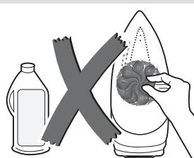
2 Para manter a base do ferro em bom estado, deve evitar que bata em objectos metálicos. Nunca limpe a base do ferro com esfregões abrasivos ou produtos químicos.
