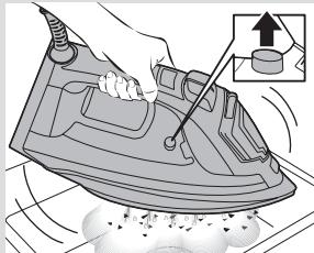
**6** Laat de "clean"-knop (reiniging) los en schud het strijkijzer een paar seconden lang voorzichtig heen en weer.
