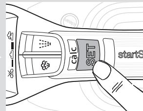
La lámpara indicadora de programa (1) parpadea. Cuando la plancha esté lista, la lámpara lucirá de forma continua.
