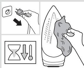
**8** Steek de stekker van het strijkijzer vervolgens in het stopcontact en laat het weer heet worden totdat de rest van het water verdampst is. Druk enkele malen op de "clean" knop om u ervan te verzekeren dat de watertank leeg is.
