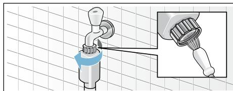
2. Почистване на филтъра от задната страна на уреда при моделите Standard и Aqua-Secure:
