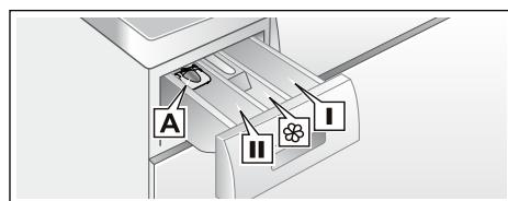
Помощ при дозиране **A** за течен перилен препарат
