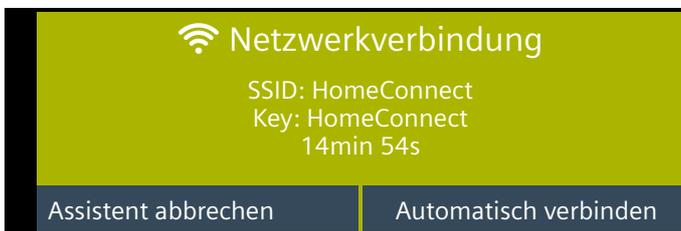
4. Mobiles Endgerät am Backofennetzwerk mit der SSID "HomeConnect" mit dem Key "HomeConnect" anmelden.
