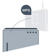
Die meisten WLAN Router haben eine WPS-Funktion. Wenn der vorhandene WLAN Router darüber nicht verfügt bzw. dies nicht bekannt ist, können Sie das Kühlgerät auch manuell mit dem Heimnetzwerk verbinden.
