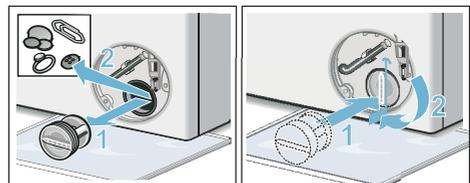
6. Service-Klappe einsetzen, einrasten und schließen.
