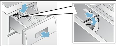
**Hinweis:** . Verwenden Sie die Dosierhilfe nicht bei gelartigen Waschmitteln und Wascpulver und bei Programmen mit Vorwäsche bzw. gewählter Fertig in-Zeit.
