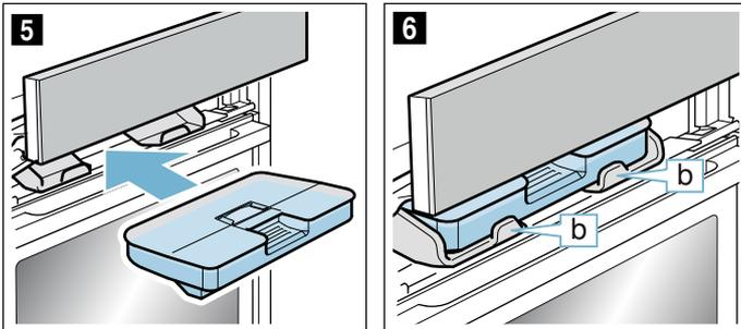
9. Desplazar la moldura lentamente hacia abajo y, a continuación, presionar hacia atrás hasta que esté completamente cerrada. El depósito de agua está lleno. Se puede iniciar el funcionamiento con vapor.
