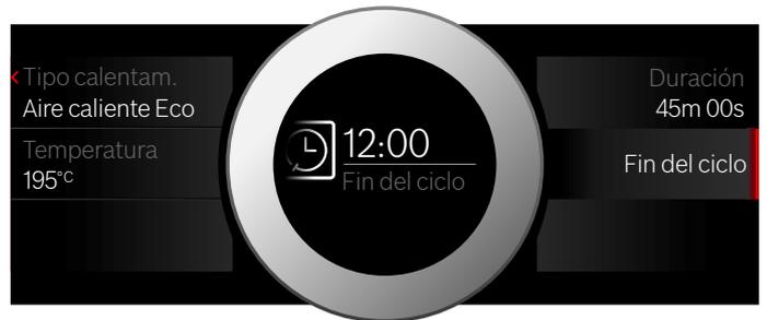
5. Iniciar con la tecla "start/stop" ▷. En la pantalla se muestra la hora a la que el aparato inicia el funcionamiento.
