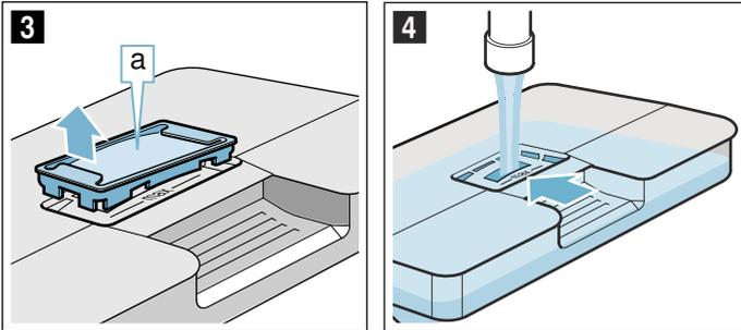
7. Volver a colocar la cubierta **a** en la abertura del depósito de agua.
