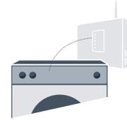
Bei der manuellen Verbindung baut Ihre Waschmaschine ein eigenes WLAN Netzwerk (Access Point) auf, in das Sie sich mit Ihrem Smartphone oder Tablet PC einwählen.
