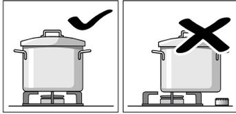
Τοποθετήστε το σκεύος καλά κεντραρισμένο πάνω στον καυστήρα. Σε αντίθετη περίπτωση μπορεί να γείρει. Μην τοποθετείτε μεγάλα σκεύη στους καυστήρες που βρίσκονται κοντά στους διακόπτες. Μπορεί να προκληθεί βλάβη λόγω υπερβολικής θερμοκρασίας.
