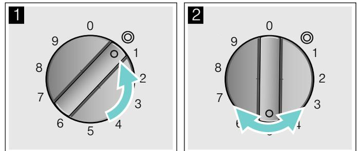
Para utilizar de nuevo la zona de cocción pequeña, gire el mando hacia la derecha hasta la posición 0 y conecte de nuevo.
