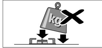
Maneje los recipientes con cuidado sobre la placa de cocción. No golpee la placa de cocción ni coloque sobre ella pesos excesivos.
