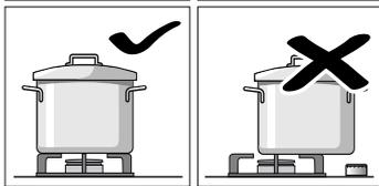
Τοποθετήστε το σκεύος καλά κεντραρισμένο πάνω στον καυστήρα. Σε αντίθετη περίπτωση μπορεί να γείρει. Μην τοποθετείτε μεγάλα σκεύη στους καυστήρες που βρίσκονται κοντά στους διακόπτες. Μπορεί να προκληθεί βλάβη λόγω υπερβολικής θερμοκρασίας.
