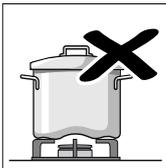
No utilice recipientes deformados que se muestren inestables sobre la placa de cocción. Los recipientes podrían volcar. Utilice solo recipientes de base plana y gruesa.
