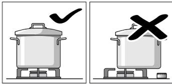
Coloque o recipiente bem centrado sobre o queimador. Caso contrário, o recipiente poderá virar-se. Não coloque os recipientes grandes sobre os queimadores próximos dos comandos. Estes podem ficar danificados devido ao excesso de temperatura.
