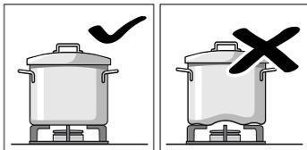
Μην χρησιμοποιείτε παραμορφωμένα σκεύη, τα οποία είναι ασταθή πάνω στην εστία. Τα σκεύη μπορεί να γείρουν. Χρησιμοποιήστε μόνο σκεύη με βάση επίπεδη και λεία.
