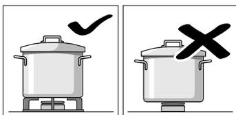
Τοποθετήστε τα σκεύη πάνω στις σχάρες, ποτέ απευθείας επάνω στον καυστήρα. Βεβαιωθείτε πριν από τη χρήση ότι οι σχάρες και τα καλύμματα των καυστήρων είναι καλά τοποθετημένα.
