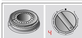
Vnější plamen na minimální, vnitřní plamen na maximální výkon.
