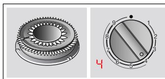
Vonkajší plameň na minimálnom, vnútorný plameň na maximálnom výkone.
