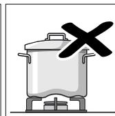
Nu utilizați recipiente deformate care se dovedesc instabile pe plita de gătit. Recipientele s-ar putea răsturna. Utilizați numai recipiente cu baza plată și groasă.
