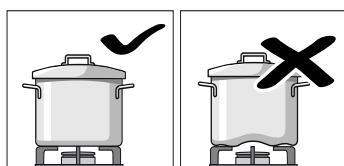
Nie należy używać odkształconych naczyń, które stoją w sposób niestabilny na płycie kuchenki i mogą się przewrócić.
