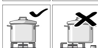
Nie stawiać dużych naczyń na palnikach blisko pokręteł. Może to spowodować uszkodzenie pokręteł na skutek wysokiej temperatury.
