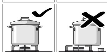
Az edényeket mindenkor közepére helyezze. Ellenkező esetben az edény felborulhat. Ne tegyen nagy edényeket azokra az égőkre, amelyek közel vannak a kapcsolókhöz. Ez károkot okozhat a túl magas hőmérséklet miatt.
