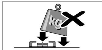
A főzőlapon lévő edényekkel óvatosan bárnjon. Ne ütögesse a főzőlapot, illetve ne tegyen rá nagy súlyt.
