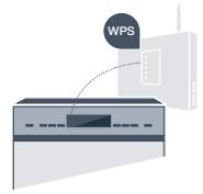
En la conexión manual, el lavavajillas crea una red WLAN propia (Access Point) a la que es posible conectarse a través del smartphone o la tableta.
