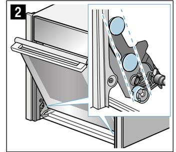
2. Girar un poco hacia arriba el tirador de la puerta **a** (Fig. 3). La puerta se desliza el último tramo restante por completo hacia abajo **b** (Fig. 3).
