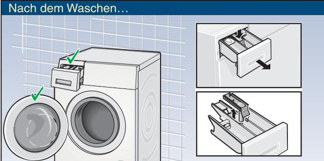
... Waschmittelschublade und Einfüllfenster offen lassen, damit Restwasser abtrocknen kann. Ggf. die Schublade herausziehen und reinigen.
