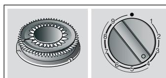
Flammes extérieures à la puissance minimale, flammes intérieures à la puissance maximale.
