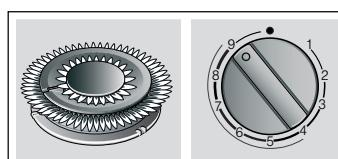
Flammes extérieures et intérieures à la puissance maximale.
