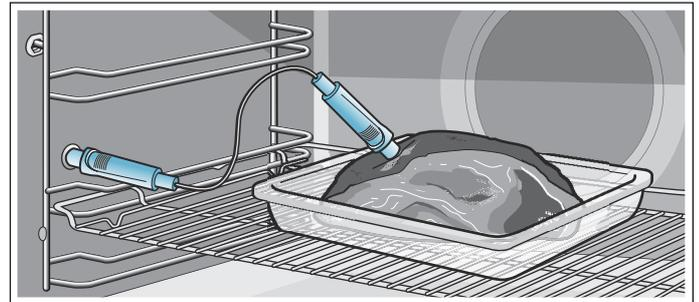
**Fisch:** Ganzen Fisch mit Hilfe einer halben Kartoffel in Schwimmposition auf den Rost stellen. Stecken Sie das Bratenthermometer hinter dem Kopf in Richtung der Mittelgräten bis zum Anschlag ein.
