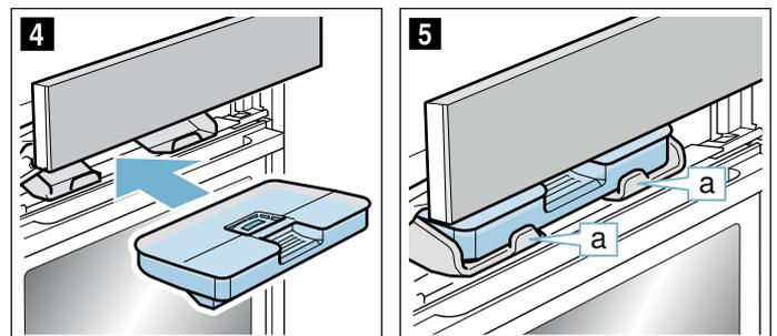
7. Blende langsam nach unten schieben, dann nach hinten drücken, bis sie vollständig geschlossen ist. Der Wassertank ist gefüllt. Sie können Betriebe mit Dampf starten.
