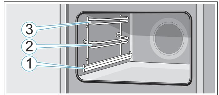
In den Einschubhöhen 2 und 3 das Zubehör immer zwischen die beiden Führungsstäbe einer Einschubhöhe schieben.
