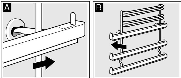
Die Gestelle passen nur rechts oder links. Achten Sie darauf, dass wie in Bild B Höhe 1 und 2 unten ist und Höhe 3, 4 und 5 oben. Die Auszugsschienen müssen sich nach vorne herausziehen lassen.
