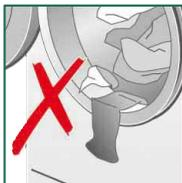
Wäschestücke nicht zwischen Einfüllfenster und Gummidichtung einklemmen.
