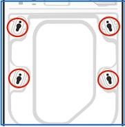
5. Abdeckungen zum Verschließen der 4 Gehäuseöffnungen einsetzen.
