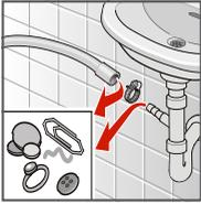
2. Schlauchschelle lösen, Ablaufschlauch vorsichtig abziehen.
