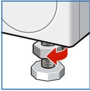
1. Kontermutter mit Schraubenschlüssel im Uhrzeigersinn lösen.
