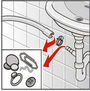
2. Schlauchschelle lösen, Ablaufschlauch vorsichtig abziehen.
