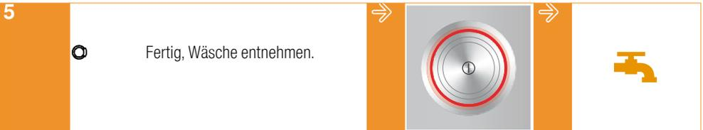
5 Programmende. Zum Ausschalten Taste ① drücken. Wasserhahn schließen (bei Modellen ohne Aquastop).
