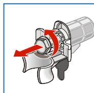
3. Alle 4 Transportsicherungsschrauben lösen und entfernen.
