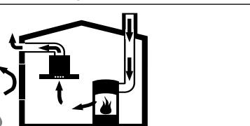
Peralatan pemanas ruangan (msl. pemanas berbahan bakar gas, minyak, kayu, atau arang, pemanas atau pemanas air berkelanjutan) mendapatkan udara pembakaran dari dalam ruangan di mana peralatan dipasang dan membuang gas sisa ke udara terbuka melalui sistem pembuangan gas (msl. cerobong asap).
