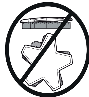
Positionnement incorrect de la cuvette du brûleur
