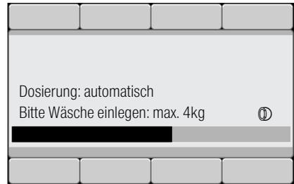
Der Beladungsbalken füllt sich beim Einfüllen der Wäsche. Ist die max. Beladung überschritten, blinkt der Balken. Beachten Sie die angegebene max. Beladung. Überfüllung mindert das Waschergebnis und fördert Knitterbildung.
