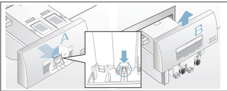
c) Zum Entleeren der Dosierbehälter jeweiligen Verschlussstopfen vorsichtig abziehen und Inhalt in ein geeignetes Gefäß ablassen.
