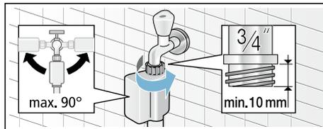
**Hinweis:** . Wasserhahn vorsichtig öffnen und dabei Dichtheit der Anschluss-Stellen prüfen. Schraubverbindung steht unter Wasserleitungsdruck.
