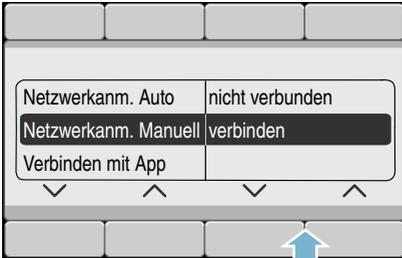
Das Gerät richtet jetzt ein eigenes WLAN Netzwerk mit dem Netzwerknamen (SSID)
