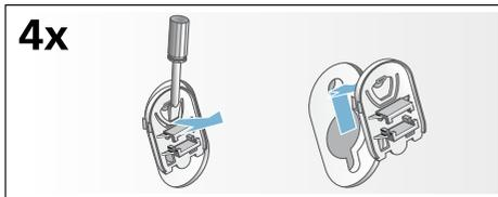
2. Alle 4 Hülsen einsetzen. Netzleitung an den Halterungen festklemmen. Transportsicherungsschrauben einsetzen und mit einem Schraubenschlüssel SW13 festziehen.
