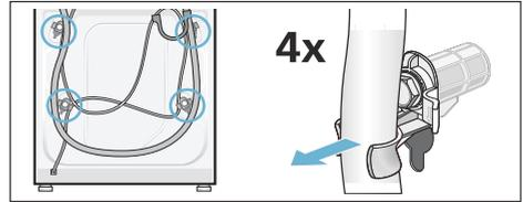
2. Alle 4 Transportsicherungs-schrauben mit einem Schraubenschlüssel SW13 lösen und entfernen. Dabei Netzleitung aus den Halterungen nehmen.
