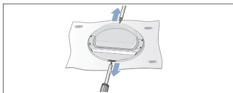
**9.** Entfernen Sie die die Ringe von der Trocknertür.
