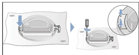
**15.** Entfernen Sie die Abdeckung vom Türschloss am Trockner und entnehmen diese.
