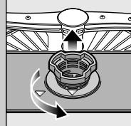
Rodar o filtro cilíndrico
