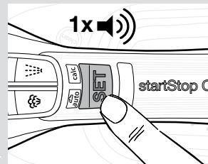
**Вы можете изменять программу глажения, последовательно нажимая кнопку «SET» (3). При каждом нажатии утюг переключается на очередную программу. Прибор будет выдавать звуковой сигнал.**
