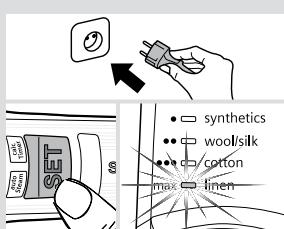
1 انزع قابس المكواة من المقبس الكهربائي، واملاً خزان الماء.
