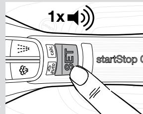
**Para cambiar el programa, pulse sucesivamente el botón de navegación SET (3).** Con cada pulsación, se selecciona el programa siguiente. Se emite un pitido.
