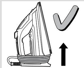
4 Неплотно намотайте шнур питания (14) на заднюю часть утюга. Храните утюг в вертикальном положении.
