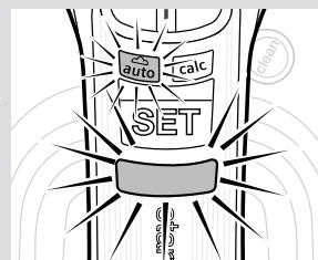
**5** Het strijkkijzer gaat automatisch naar het "allTextile" programma. Het "allTextile" indicatielampje (1) gaat knipperen ten teken dat het strijkkijzer bezig is op temperatuur te komen.
