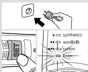
**1** Desligue o ferro da tomada de corrente e encha o reservatório de água com água.
