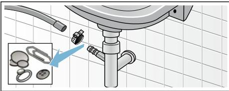
4. Encajar la manguera de evacuación y asegurar los puntos de empalme apretando la abrazadera para manguera.
