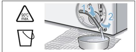
5. Desatornillar con cuidado la tapa de la bomba. Puede haber agua residual. Limpiar el compartimento interior, la rosca de la tapa de la bomba y la carcasa de la bomba. La rueda de móvil de la bomba de desagüe debe girar. Montar la tapa de la bomba en su sitio y enroscarla. El asa tiene que estar en posición vertical.
