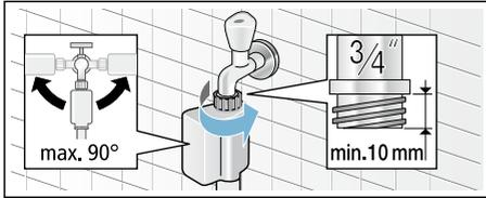
**Nota:** Abrir completamente la toma de agua y verificar la estanqueidad de los empalmes. La unión roscada se encuentra sometida a presión de agua.
