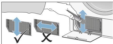
**Remarque :** Lors du nettoyage, veiller à ne pas plier ou endommager les lamelles de l'échangeur thermique.
