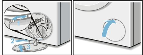
**Hinweis:** Um zu verhindern, dass beim nächsten Waschen Waschmittel ungegenutzt in den Ablauf fließt: 1 l Wasser in Kammer II gießen und Programm **Schleudern/Abpumpen** starten (soll nur abgepumpt werden: U/min (Schleuderdrehzahl) auf **0** stellen).
