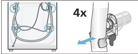
2. Alle 4 Transportsicherungsschrauben lösen und entfernen. Hülsen entfernen. Dabei Netzleitung aus den Halterungen nehmen.
