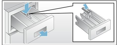
3. Einspülschale und Einsatz mit Wasser und Bürste reinigen und abtrocknen.
