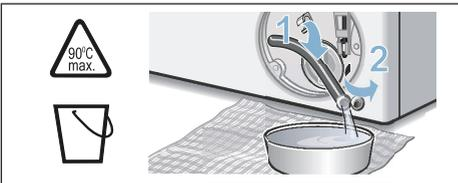
5. Pumpendeckel vorsichtig abschrauben, Restwasser kann auslaufen. Innenraum, Gewinde des Pumpendeckels und Pumpengehäuse reinigen. Das Flügelrad der Laugenpumpe muss sich drehen lassen. Pumpendeckel wieder einsetzen und verschrauben. Griff muss senkrecht stehen.
