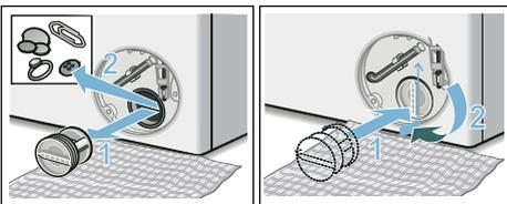
6. Service-Klappe einsetzen, einrasten und schließen.
