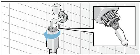
6. Sieb an der Geräterückseite reinigen: Schlauch an der Geräterückseite abnehmen. Sieb mit Zange herausnehmen und reinigen.
