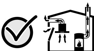
Ziehen Sie in jedem Fall den Rat des zuständigen Schornsteinfegermeisters hinzu, der den gesamten Lüftungsverbund des Hauses beurteilen kann und Ihnen die passende Maßnahme zur Belüftung vorschlägt.
