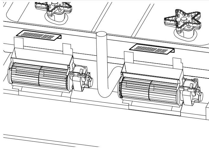
3. Pour enlever les supports du déflecteur d'air, accédez à la partie arrière de l'appareil et enlevez l'assemblage de la garniture d'ilot. Enlevez les vis qui fixent les supports à l'arrière de l'appareil. Débarrassez-vous des supports.
