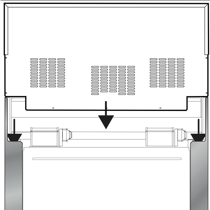
5. Asegúrese de que la parte frontal de la consola esté fuera de la pestaña en la parte delantera de la estufa.
