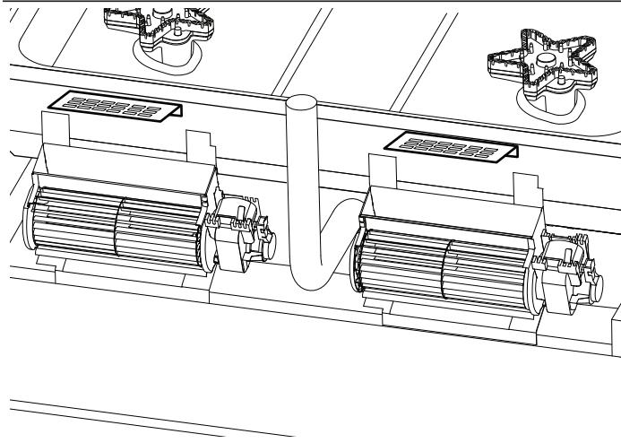
3. Para quitar los soportes del deflector de aire, acceda a la parte trasera del aparato y quite el ensamblaje del adorno de tipo isla. Quite los tornillos que sujetan los soportes a la parte posterior del aparato. Deseche los soportes.
